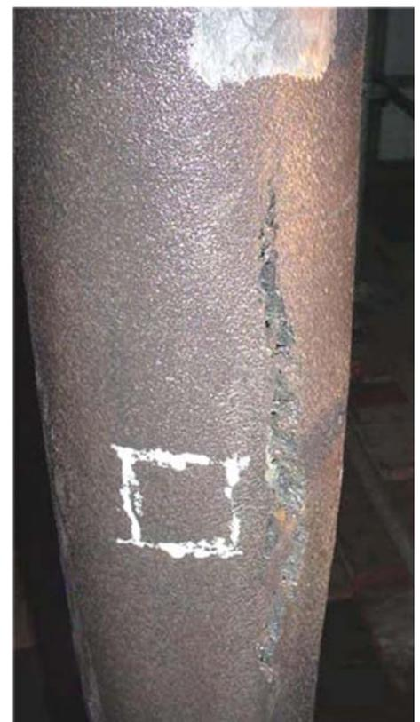
Figure 4. Tube creep rupture<sup>(6)</sup>
